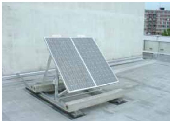
Obrázek 31: Jeden z dvojice panelů, na kterých se testoval vliv znečištění. Foto: EkoWATT
