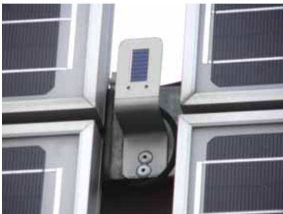
Obrázek 10: Kalibrovaný fotovoltaický článek pro měření dopadajícího slunečního záření v rovině panelů (FSV ČVUT). Foto: EkoWATT
